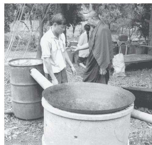
จากคุณสมบัติดังกล่าว呢 จึงควรที่เราจะต้องรู้วิธีการทำ ปกติเราจะเห็นทั่วไปใช้ถังเหล็กขนาด ๒๐๐ ลิตรอน แล้วใส่ฟืนเผา แต่ตอนนี้เราสามารถใช้ถังเหล็กขนาด ๒๐๐ ลิตรตั้ง แล้วใส่ฟืนเผา ทำให้ได้น้ำส้มควันไม้ มากกว่าแบบเดิมถึง ๓ เท่า เป็นแบบที่คิดขึ้นโดย คุณอำนวย จังสกุล จากบางระจัน ถ้าสนใจคุณอำนวย คุณอำนวย จังสกุล จากบางระจัน ถ้าสนใจ
